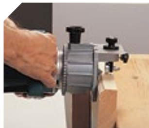
Realización de molduras.
