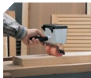
Encolado con colas vinílicas (blancas).
