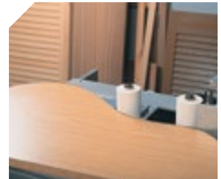
Aplacado de piezas curvas.
