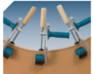
Sujeción de cantos en tableros cóncavos
