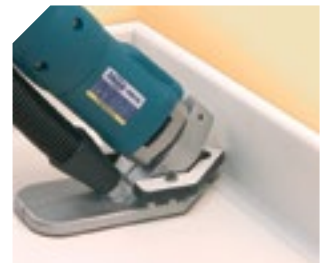
Primer fresado con la fresa de radio 10 mm.
