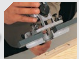
Opcional ZB93 cabezal para la colocación de pernios sin plantilla (ref. 1750000).
