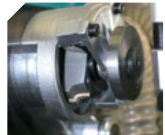
Copiador independiente de la fresa lo cual evita el marcado accidental del panel a perfilar.
