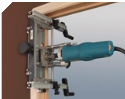
Realización del encaje superior en el marco.
