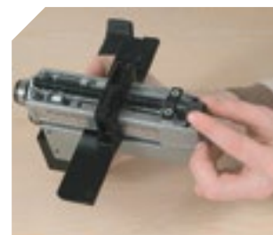
Ajuste micrométrico de la anchura de corte.
