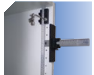
Taladrado para la colocación de bisagras invisibles.
