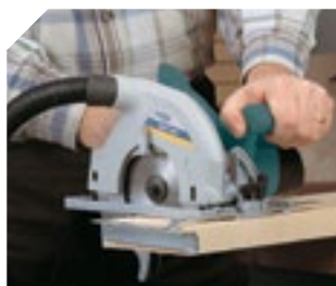
Permite realizar cortes de hasta 51 mm.
