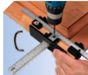
Taladrado para tiradores de puertas.
