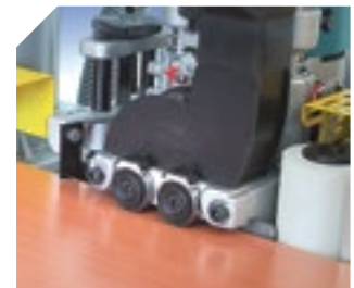
Perfilado simultáneo del canto sobrante por ambas caras, en radio o chaflán a 10°. Rascadores planos a la salida del perfilado.
