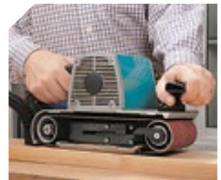
Lijado uniforme y sin surcos.
