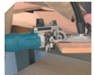
Perfilando el canto usando el filo de la fresa cilíndrica incluida.
