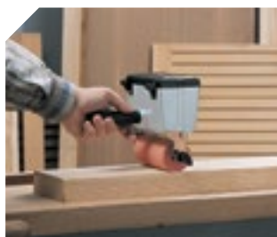
Encolado con colas vinílicas (blancas).
