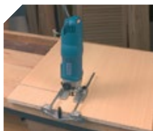
Fresado de regatas paralelas con guía lateral.
