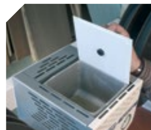
Depósito de cola de fácil acceso. Su sistema de aplicación de cola, incorpora un rodillo de silicona anti-adherente de muy fácil limpieza.
