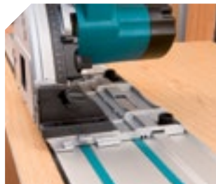
Ajuste del deslizamiento sobre el riel, preciso y sin juego.
