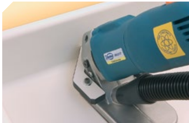
Fresado de gran calidad, integrándose totalmente el copete en la encimera, como si de una sola pieza se tratara.
