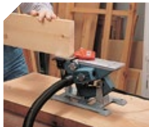
Base fijable al banco de trabajo, para utilizar el cepillo de forma estacionaria (opcional).
