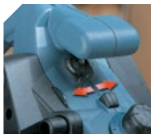
Palanca para la selección del lado de salida de viruta. Toma para aspiración externa a ambos lados.
