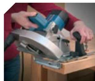
Realizando corte a inglete.
